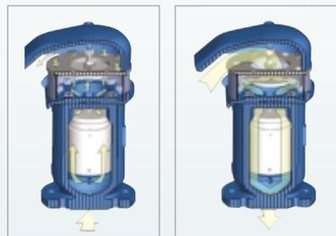
**Velocidades altas de salida del aire:** El disco (D) del SA está forzado a cerrar la salida, entonces pequeñas cantidades de aire pueden salir a través de las perforaciones del plato (E). La presión de aire aumenta, amortiguando y desacelerando la velocidad de la columna de agua.
